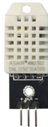
4. เซนเซอร์วัดอุณหภูมิ และความชื้น DHT22
