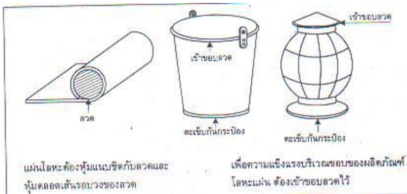
รูปที่ 8.28 แสดงการเพื่อเข้าขอบลวดแผ่นคลี่ของกล่องหรือถาด
