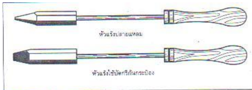
รูปที่ 7.5 แสดงลักษณะของหัวแรงด้ามตรงชนิดปลายแหลม (Pointed Copper) และชนิดปลายแบน (Flat Copper)
