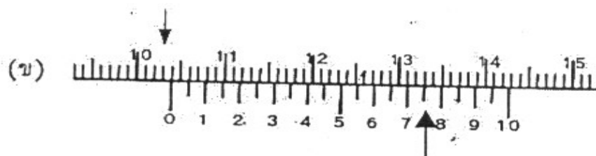
รูปที่ 2.18 การอ่านค่าของเวอร์เนีย 1/20 มม.
