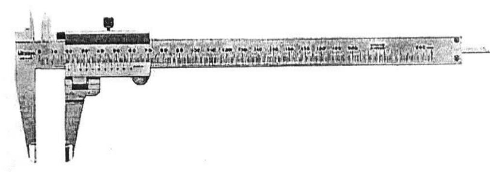
รูปที่ 2.45 เวอร์เนียแบบปากวัดโยกปรับได้ความละเอียด (0.05 มม.)
