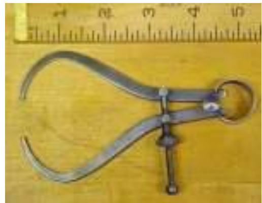
รูปที่ 5.32 การเปรียบเทียบขนาด คาลิปเปอร์จากบรรทัดวัด
