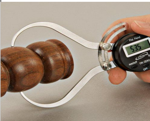
รูปที่ 5.31 การขยายคาลิปเปอร์ขวัด ทางออกพอดีกับเส้นผ่าศูนย์กลางของงาน
