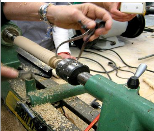
รูปที่ 5.29 การขยายคาลิปเปอร์ขวัด ทางออกใหญ่กว่าเส้นผ่าศูนย์กลางของงาน
