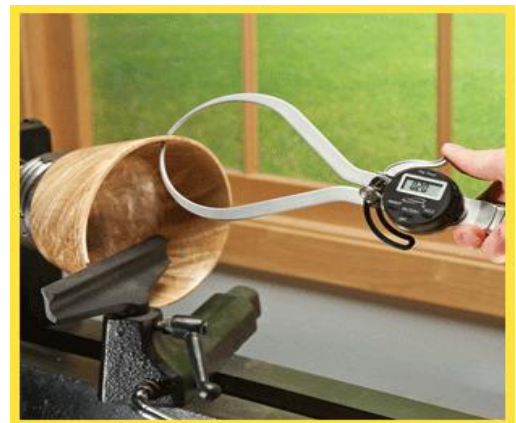
รูปที่ 5.10 การขยายคาลิปเปอร์ ขวัดทางออกเล็กกว่าศูนย์กลางของงาน
