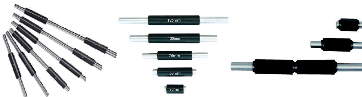
รูปที่ 3.31 แท่งทดสอบความเที่ยงตรงของไมโครมิเตอร์ขนาดต่าง ๆ
