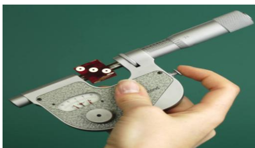
รูปที่ 3.51 ไมโครมิเตอร์ วัดนอกแบบขาหนีบและมีเข็มหน้าปัดบอกขนาด
