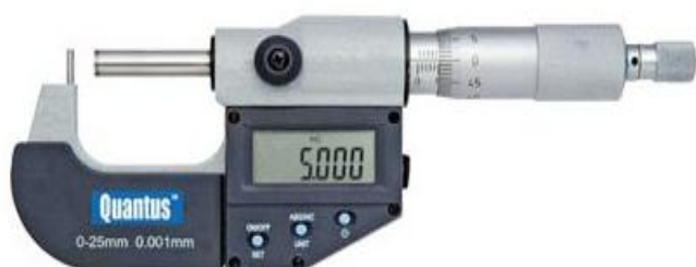
รูปที่ 3.44 ไมโครมิเตอร์ วัดความหนาของท่อ
