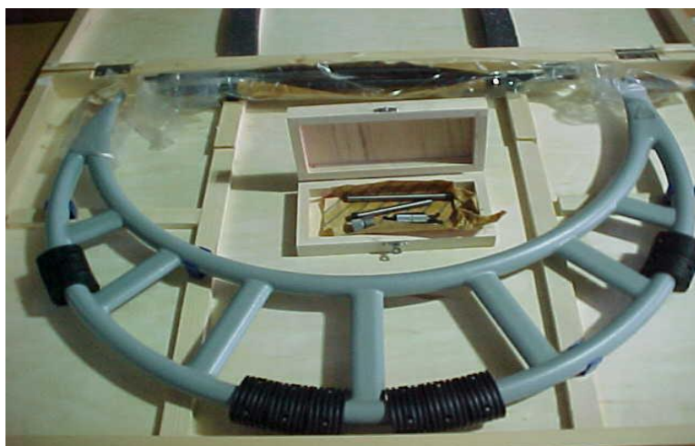
รูปที่ 3.30 การใช้ไมโครมิเตอร์ขนาดใหญ่วัดงาน
