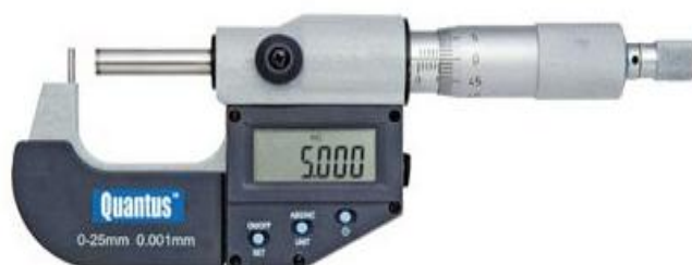
รูปที่ 3.44 ไมโครมิเตอร์ วัดความหนาของท่อ
