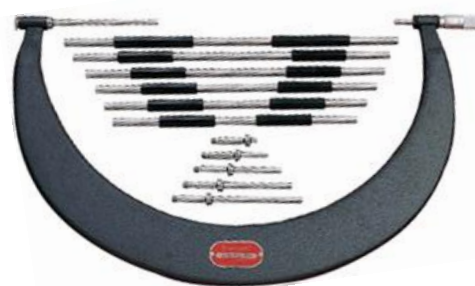
รูปที่ 3.29 ไมโครมิเตอร์แบบเปลี่ยนแกนวัดได้
