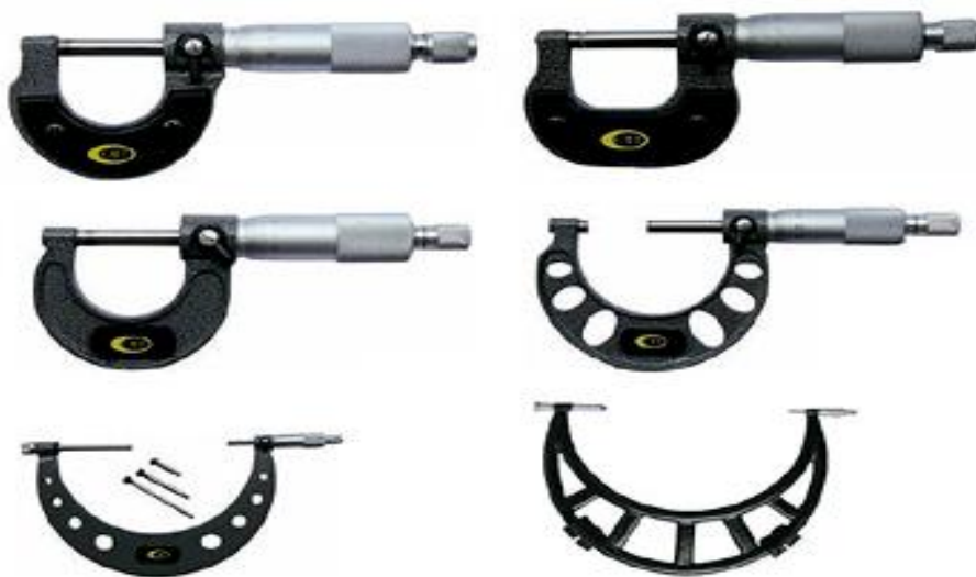
รูปที่ 3.2 ไมโครมิเตอร์ชนิดต่าง ๆ ที่มีใช้ในปัจจุบัน
