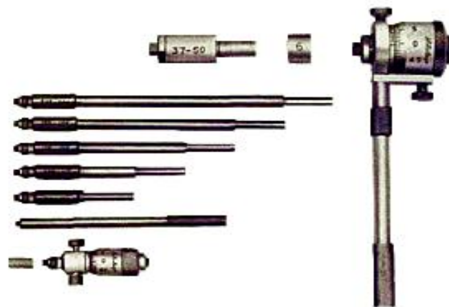
รูปที่ 3.81 ไมโครมิเตอร์วัดในแบบมีค้ำจับ
