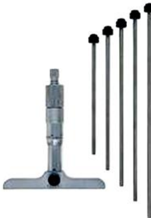
รูปที่ 3.92 ไมโครมิเตอร์วัดลึก และแกนเปลี่ยนขนาดวัด
