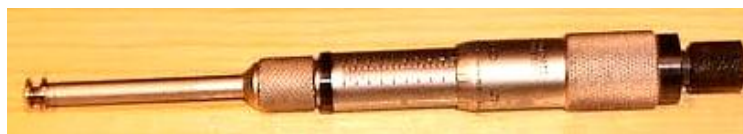
รูปที่ 3.62 ไมโครมิเตอร์สอดวัดแกนใน และลักษณะการวัดงานคุมเฟือง
