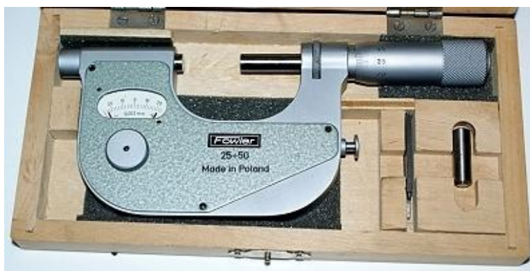
รูปที่ 3.50 ไมโครมิเตอร์ วัดนอกแบบมีเข็มบอกขนาดหรือฟักัด
