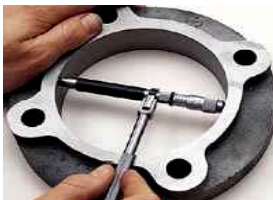
รูปที่ 3.86 การใช้ไมโครมิเตอร์วัดใน วัดงานแบบต่างๆ
