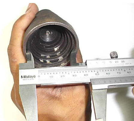
รูปที่ 2.9 วิธีใช้เขี้ยวไขว้วัดขนาดรูในชิ้นงาน
