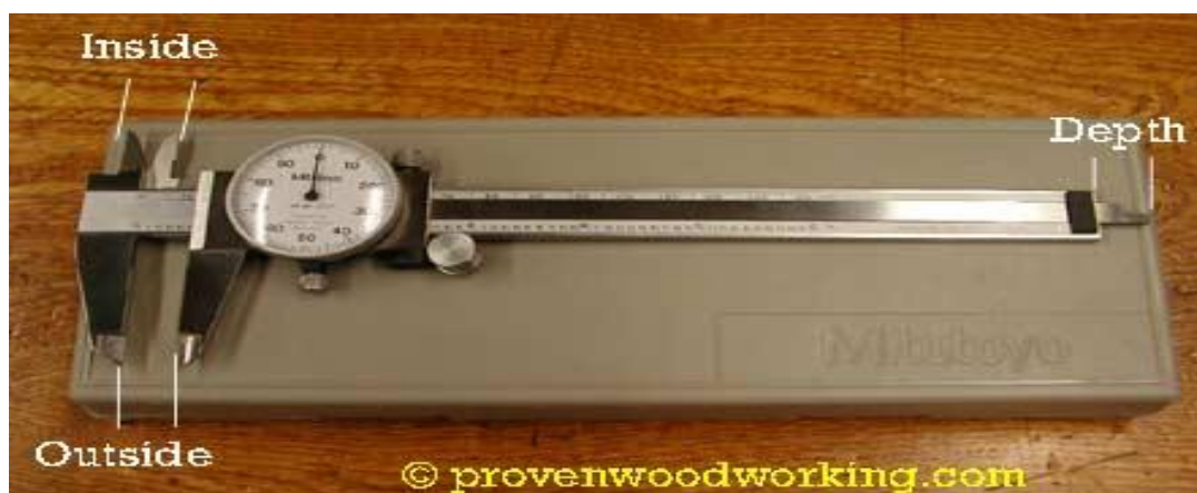
รูปที่ 2.63 เวอร์เนีย บอกรายละเอียดหน้าปัด ค่าความละเอียด 0.01 มม.
