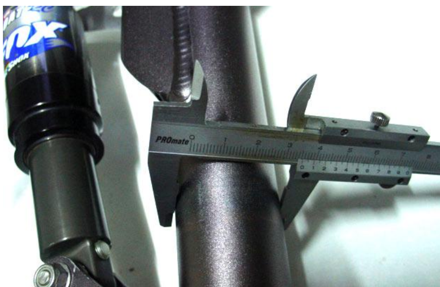
รูปที่ 2.41 การวัดงานกดสปริงขณะเลื่อนปากเวอร์เนียร์
