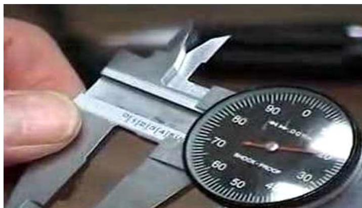
รูปที่ 2.65 เวอร์เนียร์ บอกรายละเอียดหน้าปัดค่าความละเอียด 0.05 มม.
