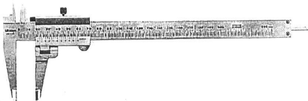
รูปที่ 2.45 เวอร์เนียแบบปากวัดโยกปรับได้ความละเอียด (0.05 มม.) เวอร์เนีย คาลิปเปอร์ ออกแบบมาให้สามารถวัดได้ โดยปรับโยกปากวัดส่วนของเวอร์เนียสเกลได้
