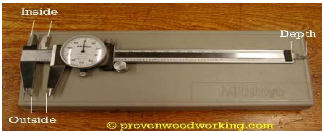
รูปที่ 2.63 เวอร์เนียร์ บอกรายละเอียดหน้าปัด ค่าความละเอียด 0.01 มม.
