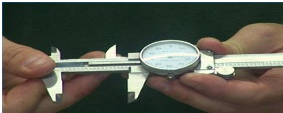
รูปที่ 2.35 เวอร์เนียร์ คาลิปเปอร์ อ่านค่าแบบนาฬิกา
