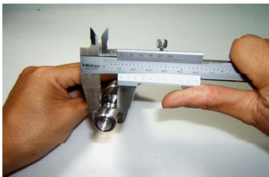
รูปที่ 2.5 วิธีใช้เวอร์เนียคาร์ลิปเปอร์วัดขนาดชิ้นงาน
