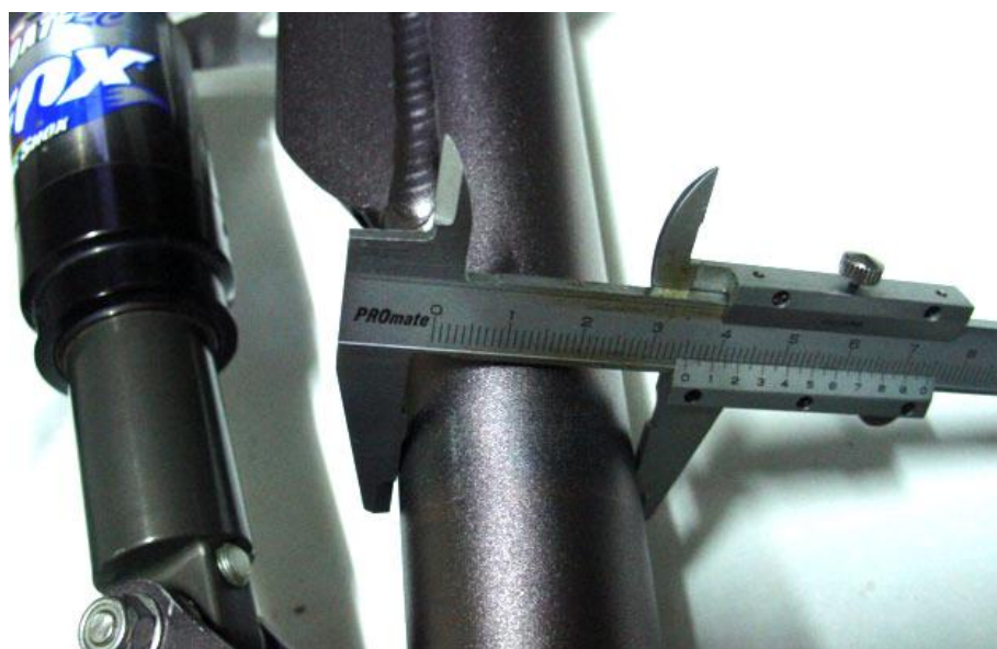
รูปที่ 2.41 การวัดงานกคสปริงขณะเลื่อนปากเวอร์เนียร์
