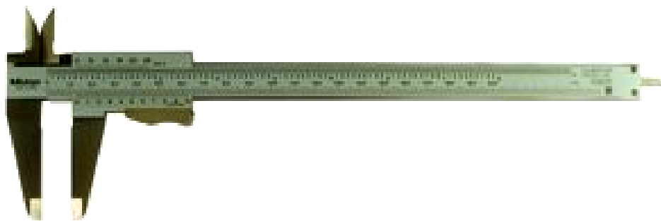
รูปที่ 2.40 เวอร์เนียร์พร้อมตัวล็อกสปริง
