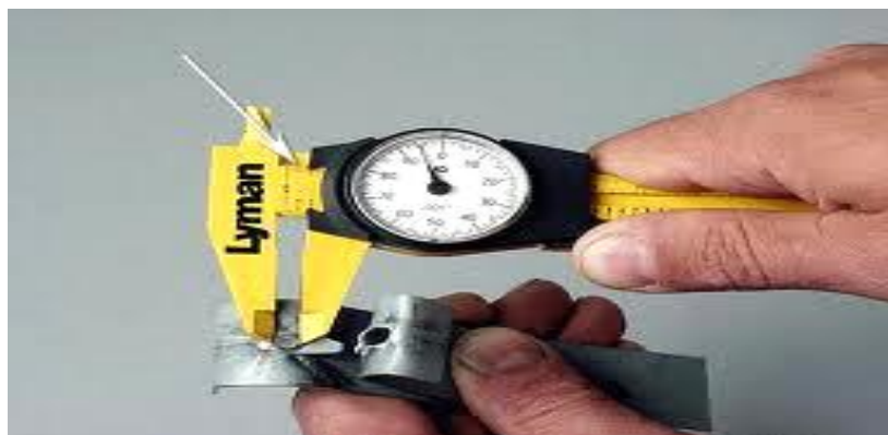
รูปที่ 2.64 เวอร์เนียร์ บอกรายละเอียดหน้าปัด ค่าความละเอียด 0.02 มม.
