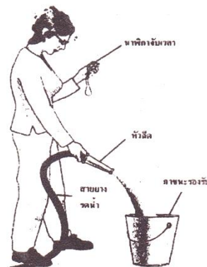
รูปที่ 10.1 แสดงการวัดอัตราการไหลโดยตรง
