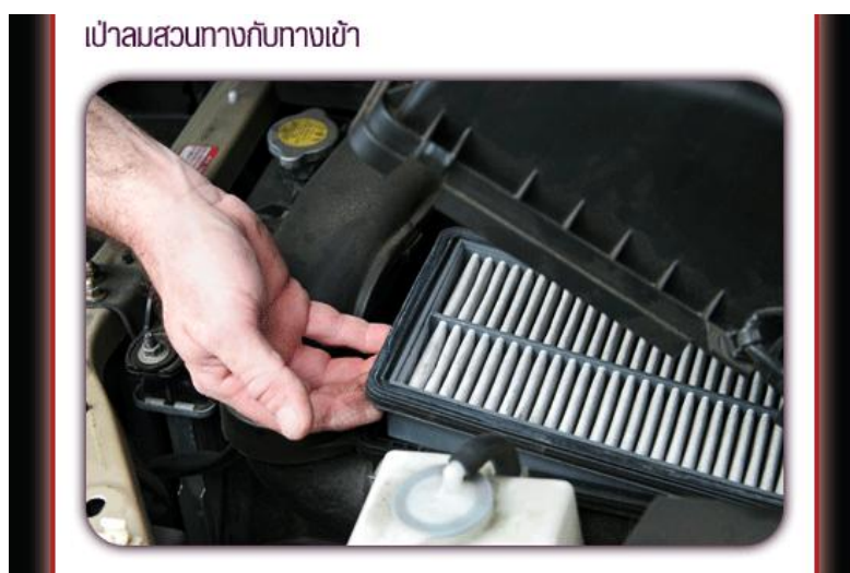
รูป11.10 แสดงการทำความสะอาดกรองอากาศ
