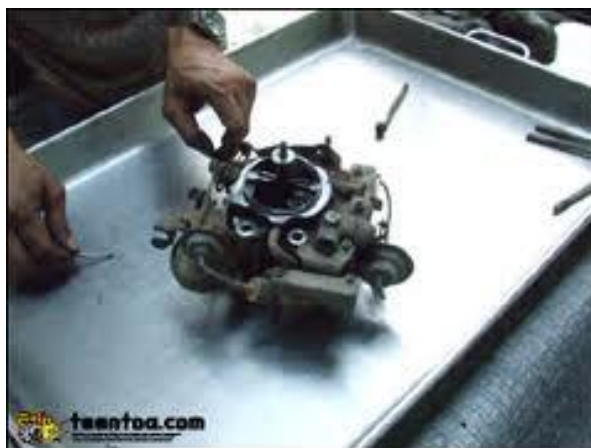
รูปที่11.8 แสดงล้างทำความสะอาดคาร์บูเรเตอร์
