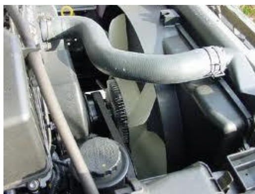
รูปที่ 10.4 ถอดท่อน้ำเข้าออกจากเครื่องยนต์
