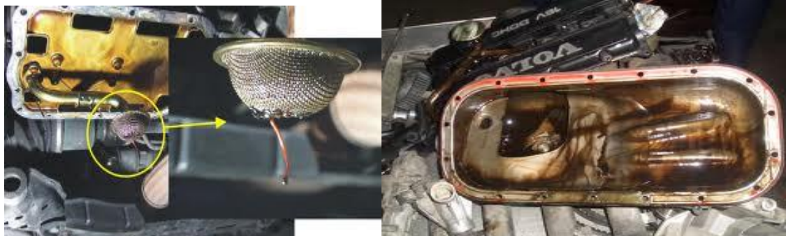
รูปที่ 10.5 ถอดอ่างน้ำมันเครื่องตะแกรงกรอง
