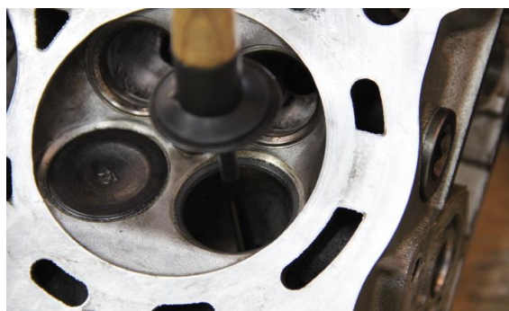
รูปที่ 10.16 การบดลิ้นของเครื่องยนต์
