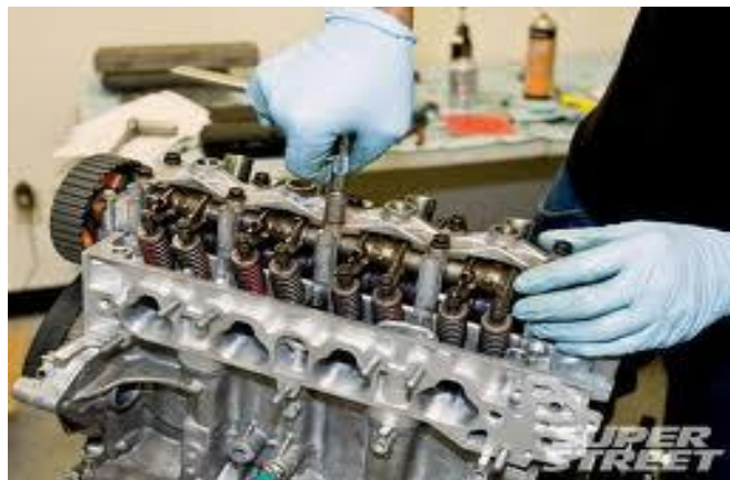
รูปที่ 10.11 ถอดและประกอบเพลาลูกเบี้ยว
