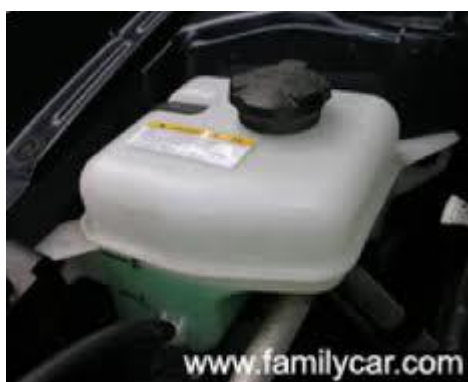
รูปที่ 8.9 ถังน้ำสำรอง
