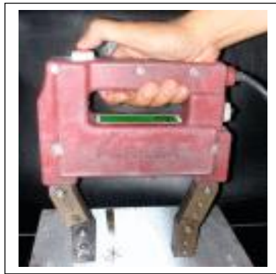
รูปที่ 12.1 การตรวจสอบด้วยเส้นแรงแม่เหล็ก
