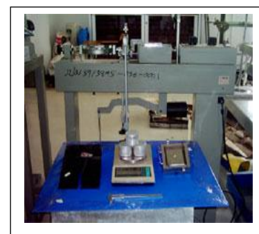
รูปที่ 12.6 การทดสอบความสามารถรับแรงดึง แรงกด และแรงเฉือน
