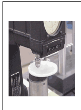
รูปที่ 12.5 อุปกรณ์ เครื่องทดสอบแบบร็อกเวล (Rockwell Test)
