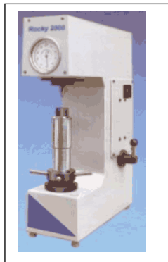
รูปที่ 12.5 อุปกรณ์ เครื่องทดสอบแบบร็อกเวล (Rockwell Test)
