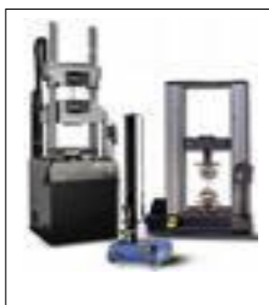
รูปที่ 12.6 การทดสอบความสามารถรับแรงดึง แรงกด และแรงเฉือน
