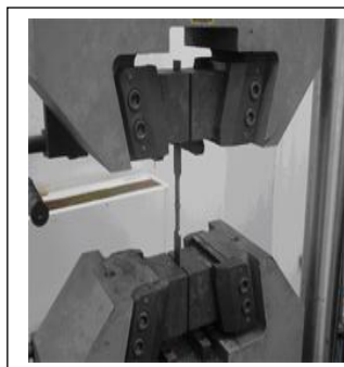
รูปที่ 12.6 การทดสอบความสามารถรับแรงดึง แรงกด และแรงเฉือน
