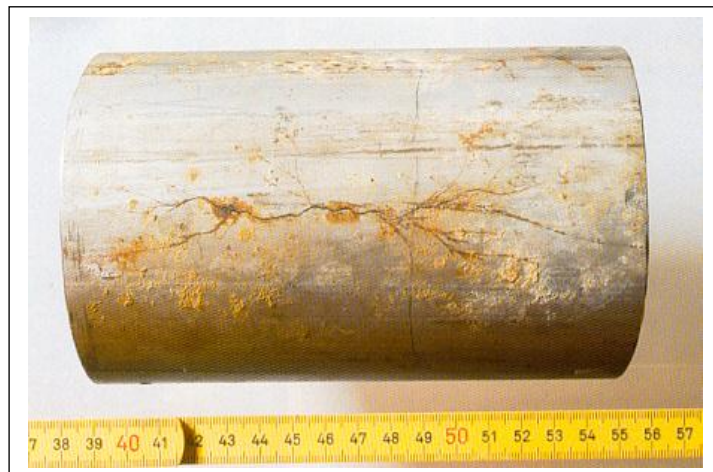
รูปที่ 11.2 การกัดกร่อนเป็นกระบวนการเสื่อมสภาพของโลหะหรือโลหะผสม เนื่องมาจากการทำปฏิกิริยากับสิ่งแวดล้อม
