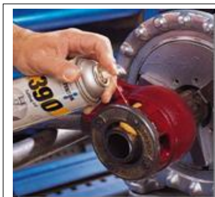
รูปที่ 11.1 การเติมน้ำมันหล่อลื่นในเครื่องจักร
