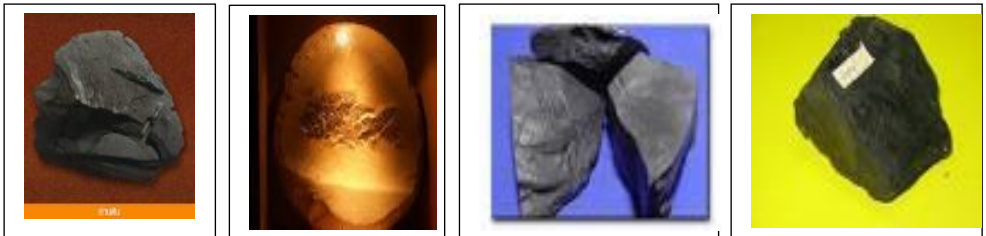
รูปที่ 5.11 ถ่านพีต ลิกไนต์ บิทูมินัส และแอนตราไซต์ (เรียงจากซ้ายไปขวา)
