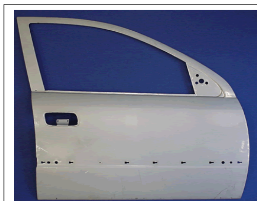
รูปที่ 2.8 ประตูดยนต์ผลตจากเหล็กกลาคารบอนต่ำ
