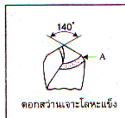
รูปที่ 7.19 แสดงวิธีการลับคมตัด ของดอกสว่านเพื่ เจาะโลหะ
