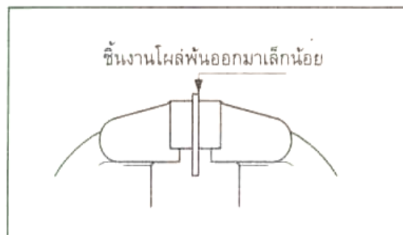
รูปที่ 2.56 แสดงการจับชิ้นงาน เพื่อป้องกันการลื่นและติดตัว
