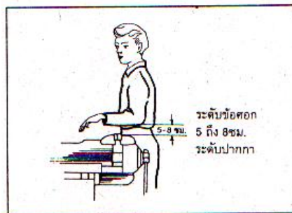
รูปที่ 5.21 แสดงความสูงของปากกาจับชิ้นงานที่เหมาะสมในการตะไบ
