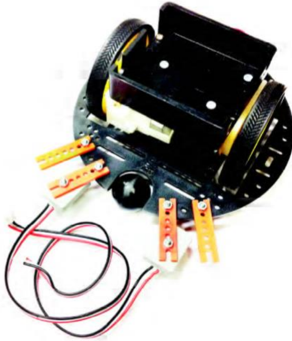
รูปที่ 16.18 การนำแท่งต่อ 5 รู ยึดเข้าที่ด้านหน้าของฐานหุ่นยนต์
