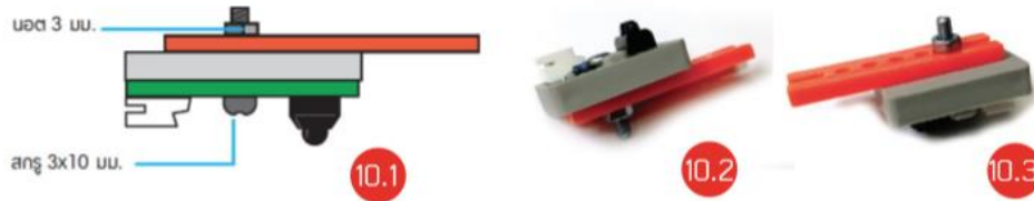
รูปที่ 16.5 การนำแท่งต่อ 5 รู ติดตั้งเข้ากับแผงวงจรตรวจจับเส้น ZX-03
