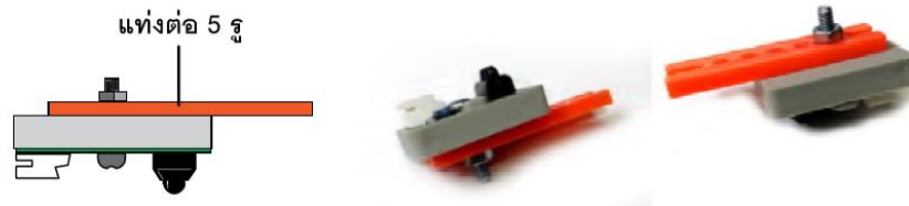
รูปที่ 16.16 การนำแผงวงจรตรวจจับแสงสะท้อนอินฟราเรด ZX-03 ยึดเข้ากับแท่งต่อ 5 รู
