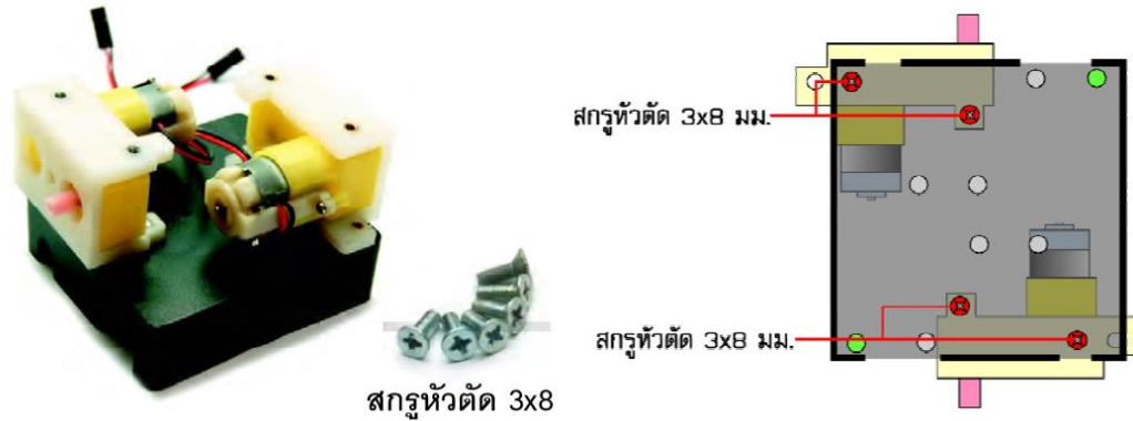
รูปที่ 16.12 การนำชุดเฟืองขับมอเตอร์ยึดเข้ากับถาดรองกะบะถ่าน
