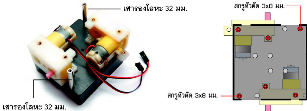
รูปที่ 16.13 นำเสาทองโลหะยึดเข้ากับถาดรองกะบะถ่าน
