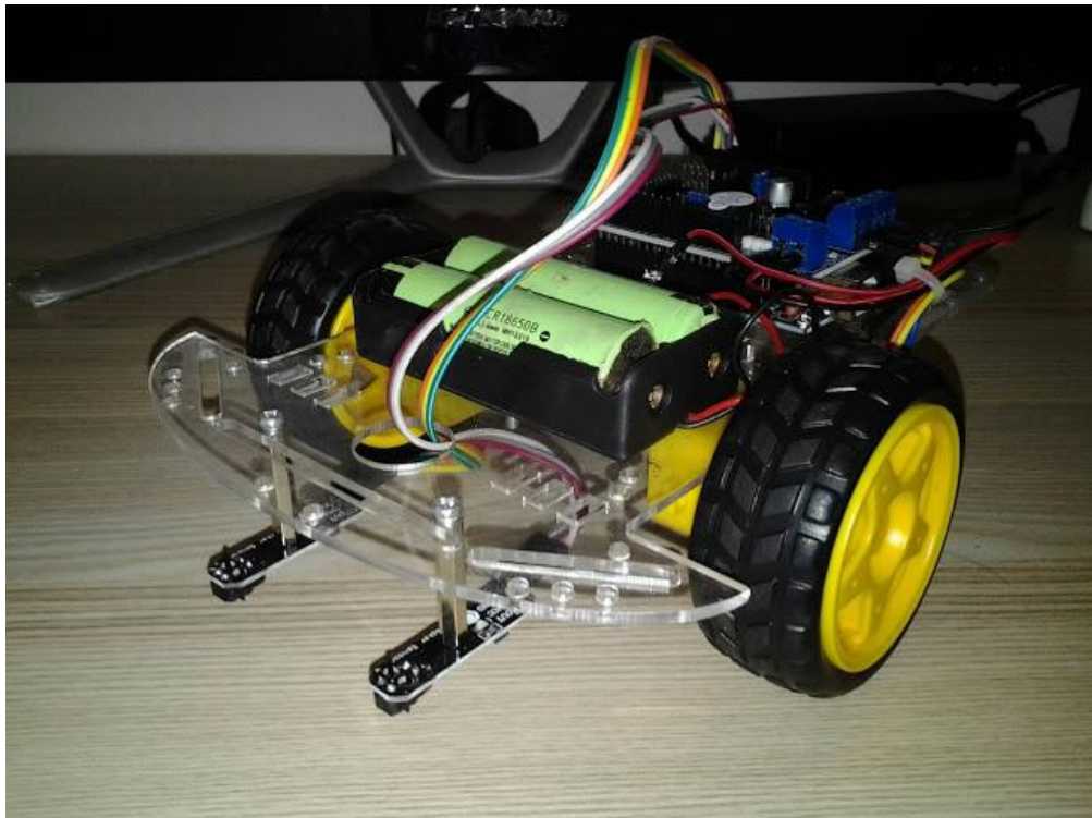
รูปที่ 12.3 หุ่นยนต์เดินตามเส้น 2 เซ็นเซอร์ Arduino + L298P
