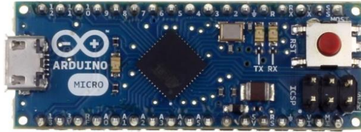
รูปที่ 11.9 บอร์ด Arduino Micro
