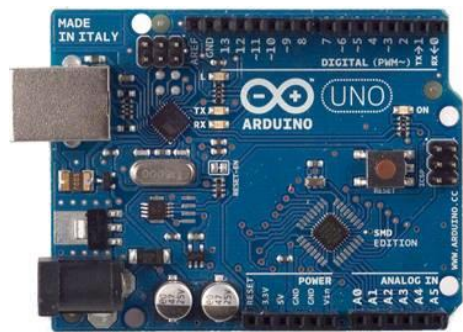
รูปที่ 11.4 บอร์ด Arduino Uno SMD
