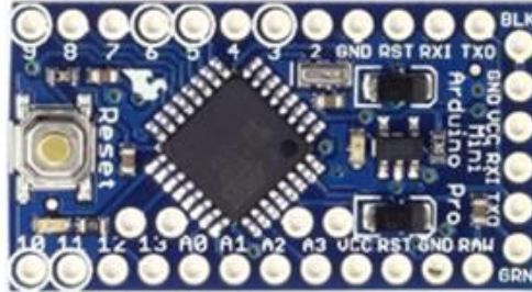
รูปที่ 11.12 บอร์ด Arduino Pro Mini
