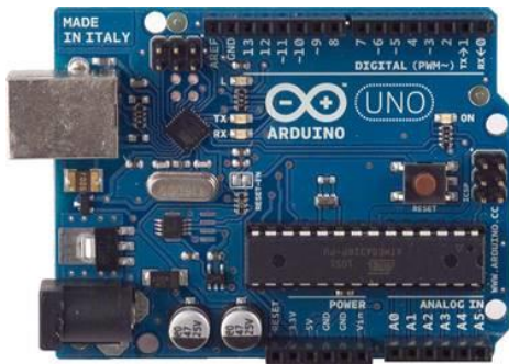
รูปที่ 11.3 บอร์ด Arduino Uno R2
