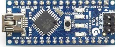
รูปที่ 11.10 บอร์ด Arduino Nano
