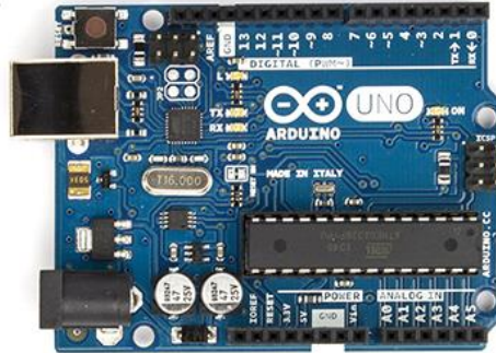
รูปที่ 11.2 บอร์ด Arduino Uno R3
