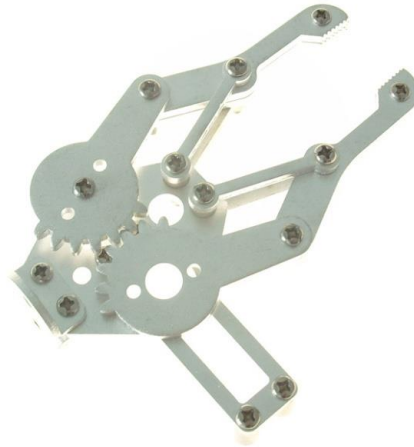
รูปที่ 6.8 แสดงการออกแบบกลไกมือจับ
