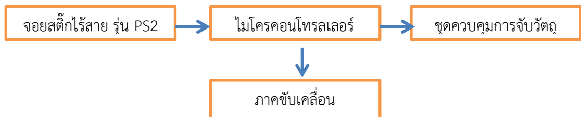
รูปที่ 6.9 แผนผังการทำงานของ Arduino Wireless Robot
