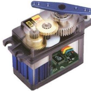
ภาพที่ 4.21 แสดงโครงสร้างเซอร์โวมอเตอร์
