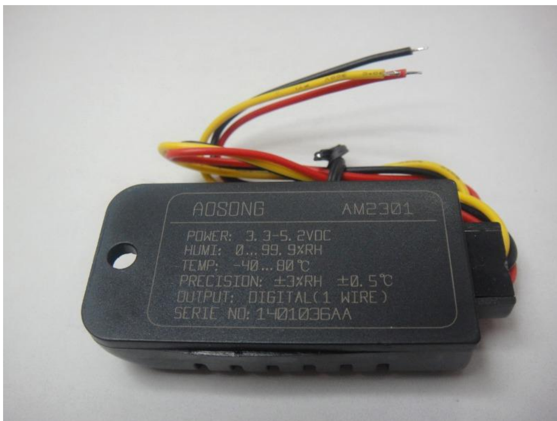
รูปที่ 10.1 แสดงโมดูลเซนเซอร์วัดอุณหภูมิและความชื้นสัมพัทธ์ โมเดล AM2301 (ด้านหลัง) (ที่มา www.Cpre.kmutnb.ac.th/es/learning/index.php?article )
