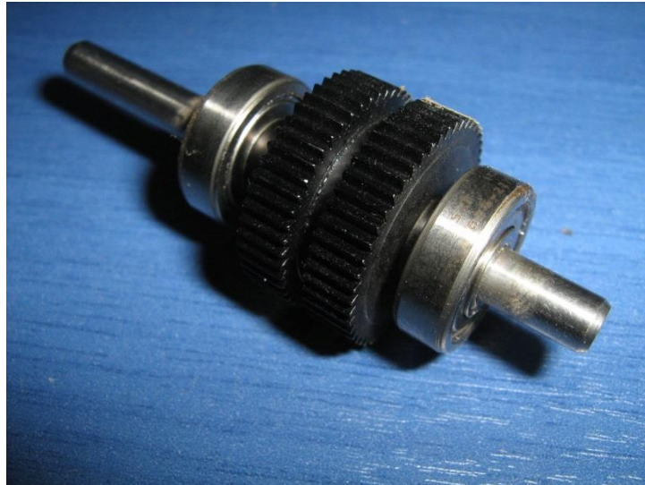
รูปที่ 8.16 ลักษณะของแกนโรเตอร์แบบแม่เหล็กถาวรมีซี่ (Teeth) (ที่มา www.Pcbheaven.com )
