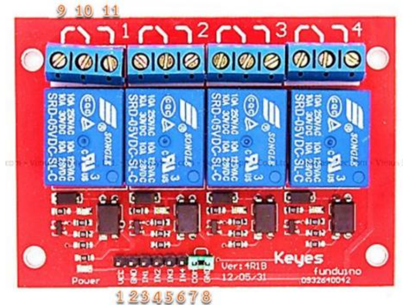
รูปที่ 7.8 แสดงขาที่ใช้ในการเชื่อมต่อของ Relay Module 4 Channels (ที่มาจาก www.Thaieasyelec.com )
