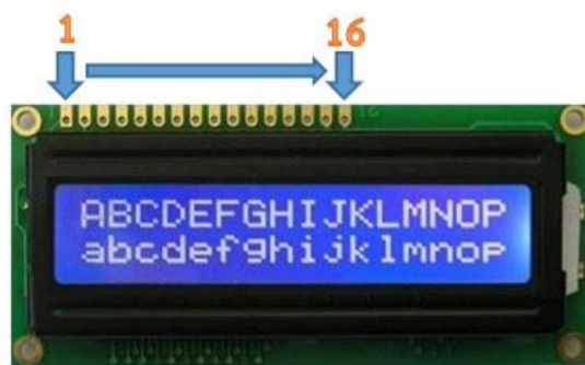
รูปที่ 6.9 รายละเอียดการต่อขาจอ LCD 16x2 Character (I2C)
