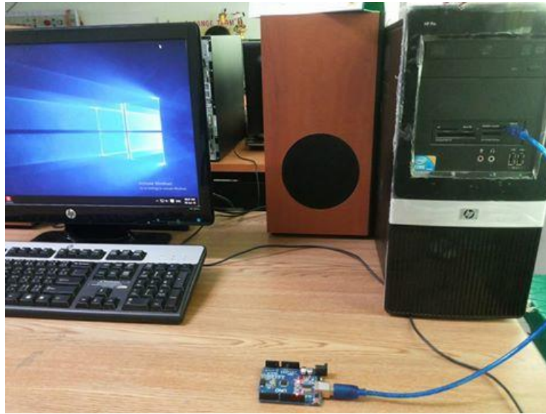
รูปที่ 2.25 การต่อบอร์ด Arduino กับคอมพิวเตอร์
